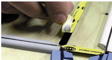
Fig 4. La correcta combinación de la pleca / contramolde es necesaria para obtener resultados óptimos.
