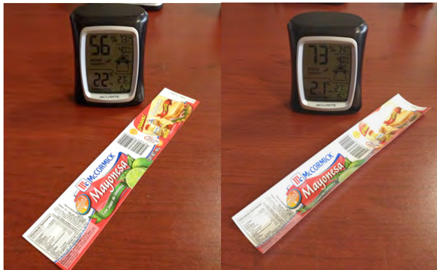
Figura 13. Etiqueta expuesta a 56% HR (plana) y a 73% HR (curvada)
