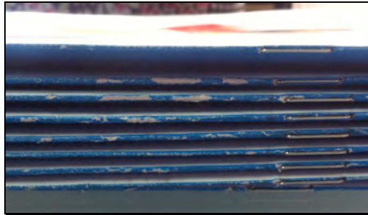
Figura 12. Quebre de recubrimiento ocasionado por baja humedad relativa
