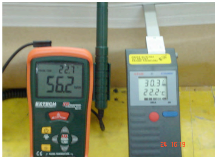
Figura 11. Diferencia excesiva entre la HR del taller (56%) y la HR del papel (30%)
